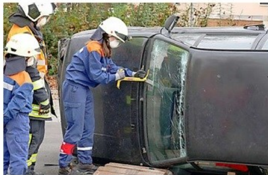
Eine Jugendliche schneidet mit einer Spezialsäge die Frontscheibe aus einem „verunfallten“ Auto.
